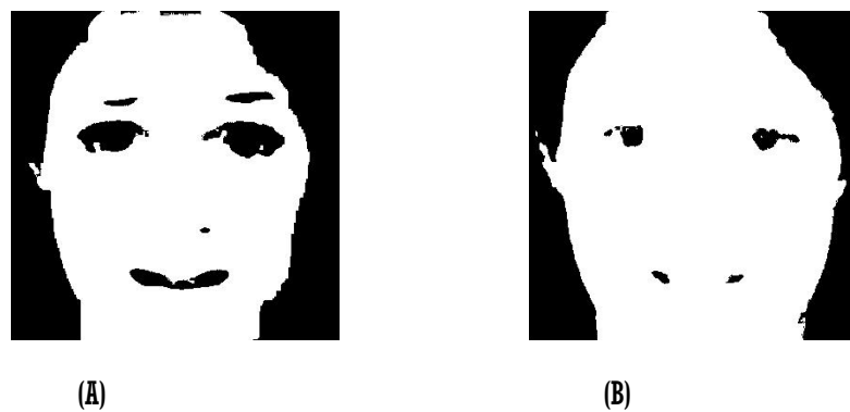
FIGURA 2.5(A) IMAGEN CON UMBRAL APLICADO DE 75, (B) IMAGEN CON UMBRAL APLICADO DE 30.
