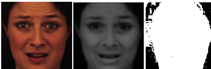
FIGURA 2.7.DE IZQUIERDA A DERECHA, IMAGEN ORIGINAL (A), RESTA DE CANALES (B) E IMAGEN BINARIZADA(C)
